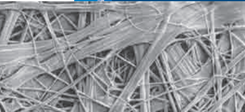
Фотография структуры мембраны Tyvek® при увеличении в 200 раз
