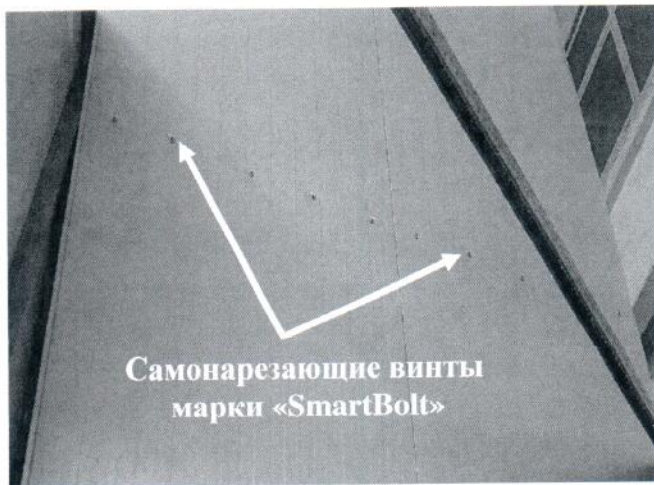
Рисунок 1.9 Крепление трехслойных сэндвич-панелей к горизонтальной балке стенда
