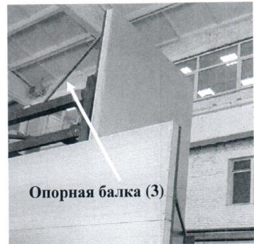
Рисунок 1.9 Крепление трехслойных сэндвич-панелей к горизонтальной балке стенда
